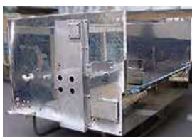
ワイヤーカット用タンク 鏡面仕様SUS2.0t製
